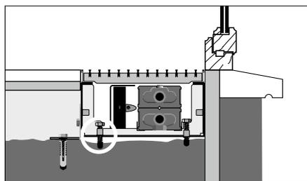
Деталь для регулировки высоты снабжена дополнительными регулировочными винтами, чтобы выровнять короб относительно оконной рамы.
